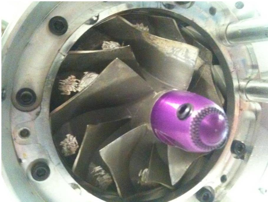
Abb. 4.5 Verdichterlaufrad mit Wuchtmarkierungen
