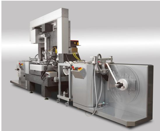
**Bild 6** Das Thermodenfeld härtet die Klebeverbindung unter Druck und Temperatur aus
