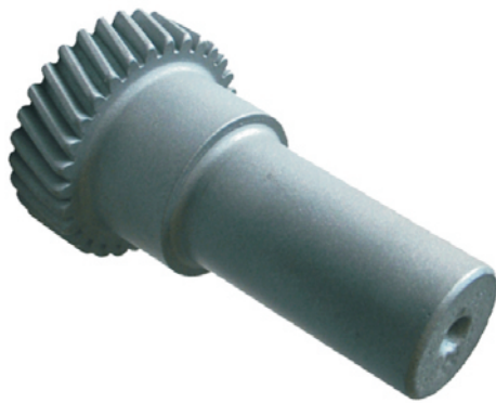
Abbildung 2: Präzisionsgeschmiedete Ritzelwelle des SFB 489
