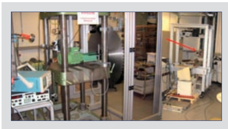
Bild 12 Messaufbau im Versuchsfeld (Remscheid) mit Derotator (roter Pfeil rechts im Bild)
