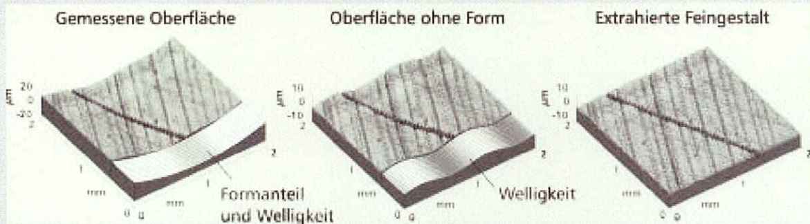
Bild 2: Datenvorverarbeitung zur Auswertungen von Zylinderlaufbahnen. Figure 2: Data pre-processing for the evaluation of cylinder liners
