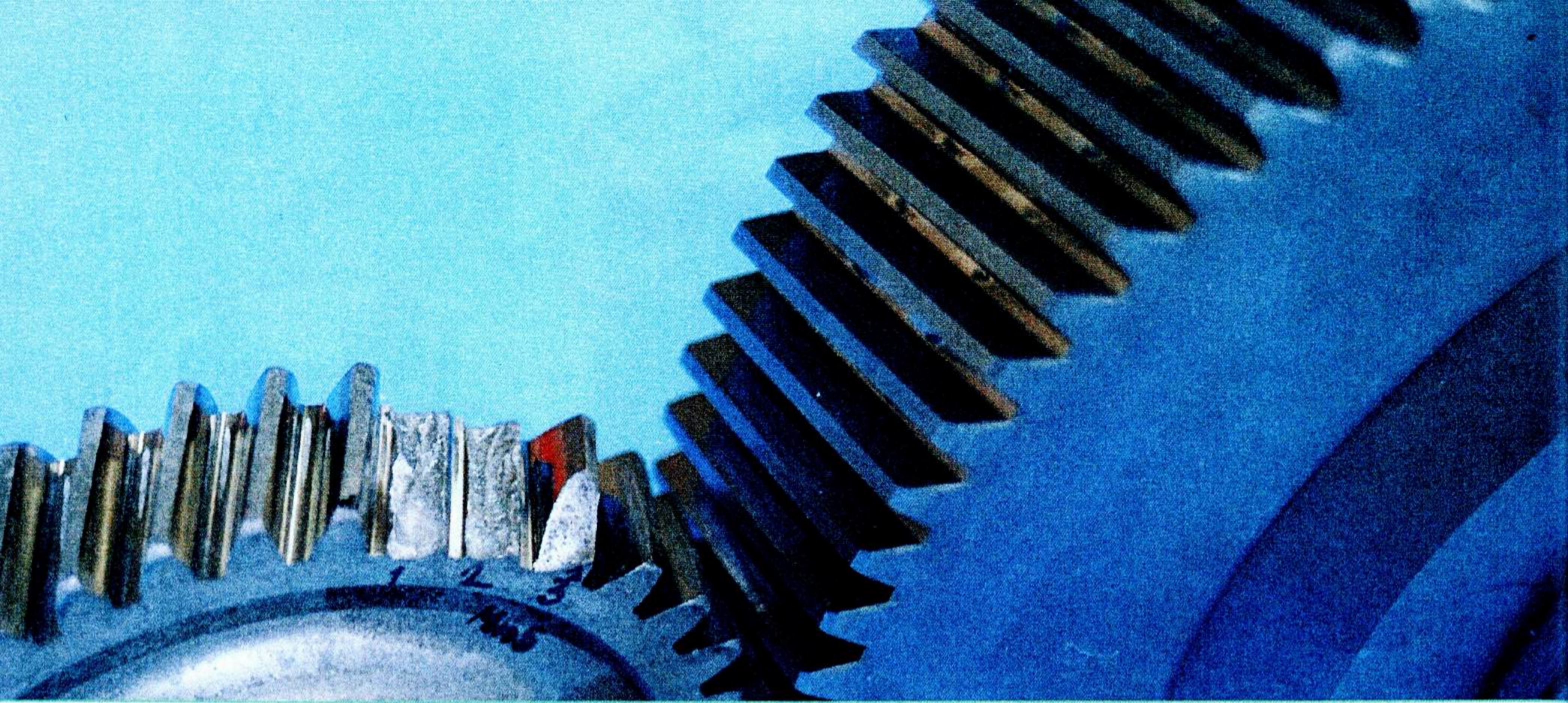
Ausfall eines Getriebes durch Zahnbruch Bild: © IW
